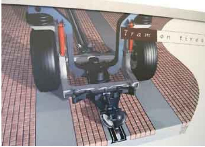
الشكل 8 : عربة ترام واي وفق Translohr بسكة مركزية ودواليب مطاطية
